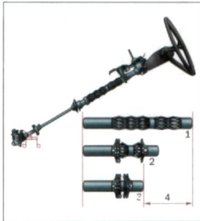
Рисунок 1 – травмобезопасная рулевая колонка
