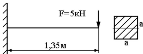
Задача №6: Выполнить расчет с применением естественно научных знаний и методов механического анализа, а именно: определить максимальный прогиб стальной балки способом Верещагина.
