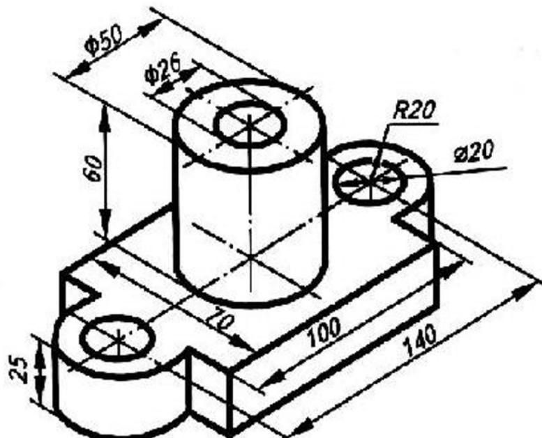
6.Задание на использование прикладной программы для моделирования и проектирования Компас-3D
