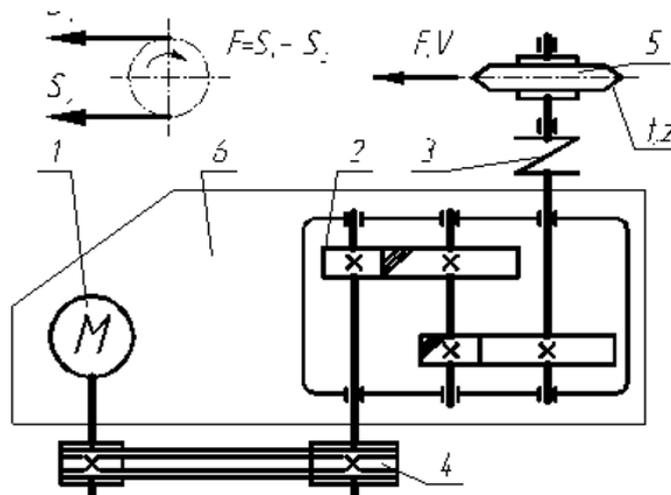
Методами инженерных расчетов определить общее передаточное число привода, произвести разбивку общего передаточного числа по ступеням привода, назначить тип электродвигателя при частоте вращения вала машины  $n_{\text{вых}} = 30 \text{ мин}^{-1}$ ,  $P_{\text{вых}} = 3 \text{ кВт}$ .
