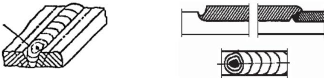
Рисунок 7 – Эскиз дефекта сварного шва
