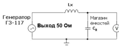
Рисунок – Принципиальная схема для измерения индуктивности
