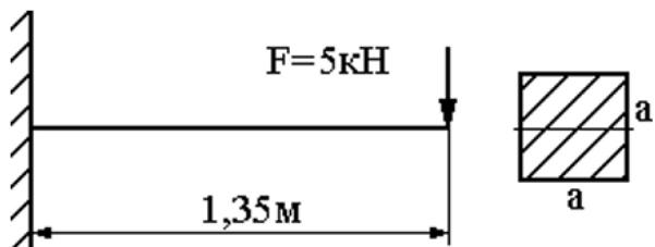
Задача №3 Выполнить расчет с применением естественно научных знаний и методов механического анализа, а именно: определить максимальный прогиб стальной балки способом Верещагина.
