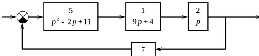
**Требуется:** применяя современные программно-технические средства, получить график импульсной переходной (весовой) функции данной системы. (ПК-4.2).
