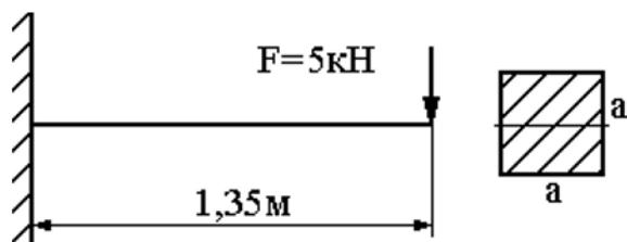
Задача №6: 3 Выполнить расчет с применением знаний о свойствах конструкционных и электротехнических материалов, а именно - определить максимальный прогиб стальной балки способом Верещагина.
