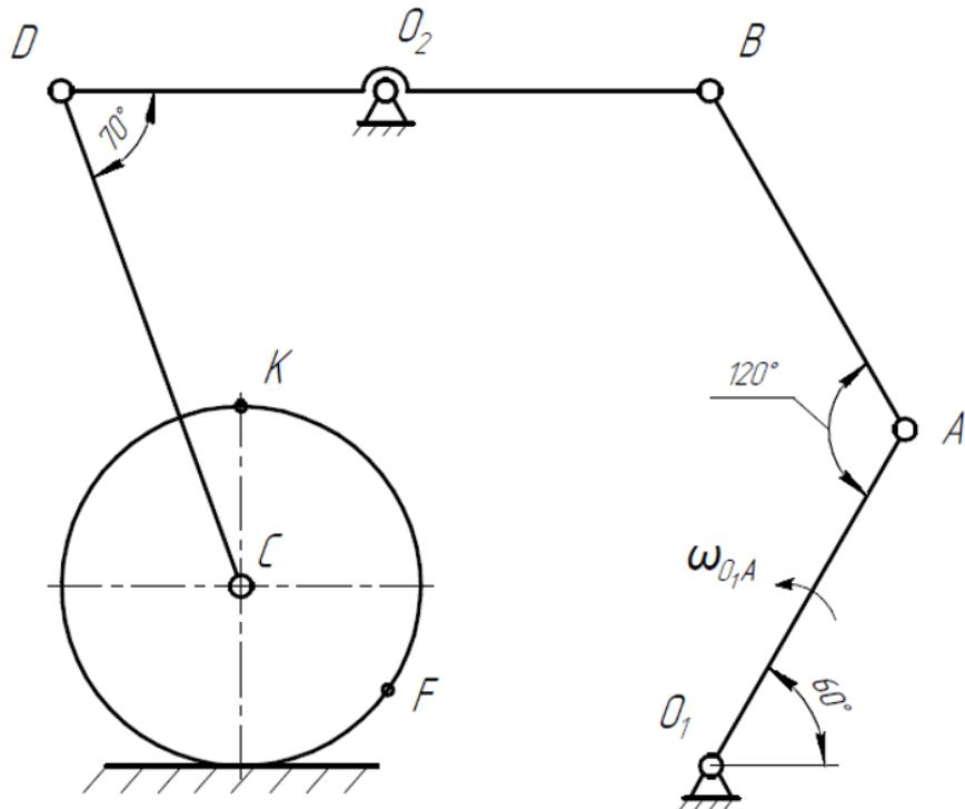
Сформулируйте задачи структурного и кинематического анализа, проведите структурный анализ данного механизма, решите научно-техническую задачу по определению степени подвижности механизма, решите инженерную задачу по определению скоростей и ускорений обозначенных точек механизма графоаналитическим методом. **(ОПК-1.1)**
