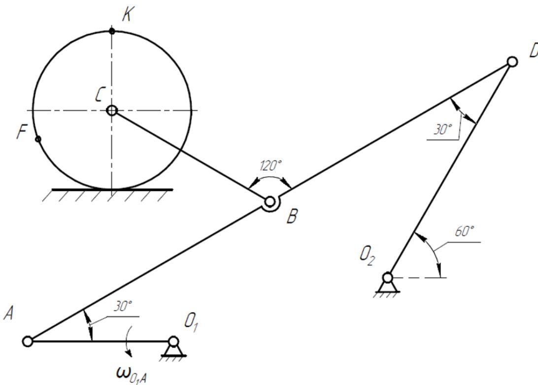
Сформулируйте задачи структурного и кинематического анализа, проведите структурный анализ данного механизма, решите научно-техническую задачу по определению степени подвижности механизма, решите инженерную задачу по определению скоростей и ускорений обозначенных точек механизма графоаналитическим методом. (**ОПК-1.1**)
