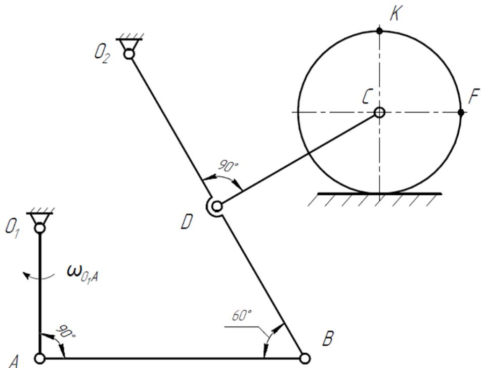
Сформулируйте задачи структурного и кинематического анализа, проведите структурный анализ данного механизма, решите научно-техническую задачу по определению степени подвижности механизма, решите инженерную задачу по определению скоростей и ускорений обозначенных точек механизма графоаналитическим методом. **(ОПК-1.1)**
