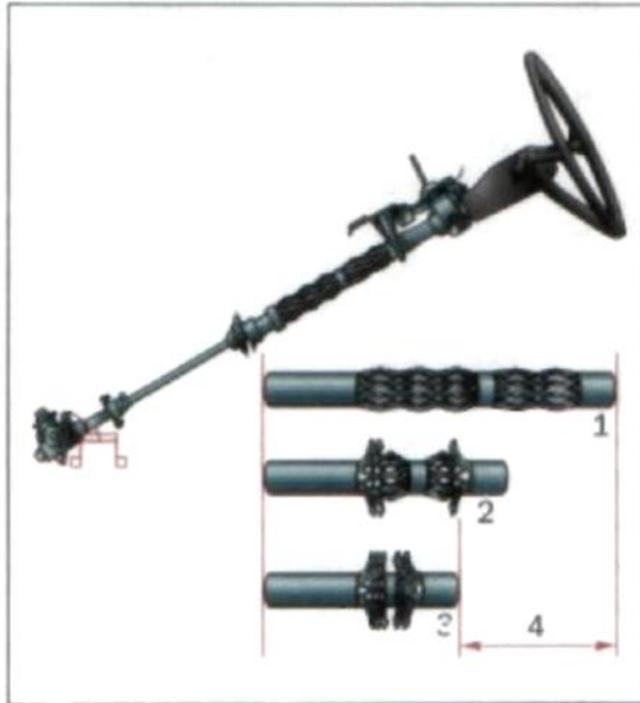
Рисунок 1 – травмобезопасная рулевая колонка
