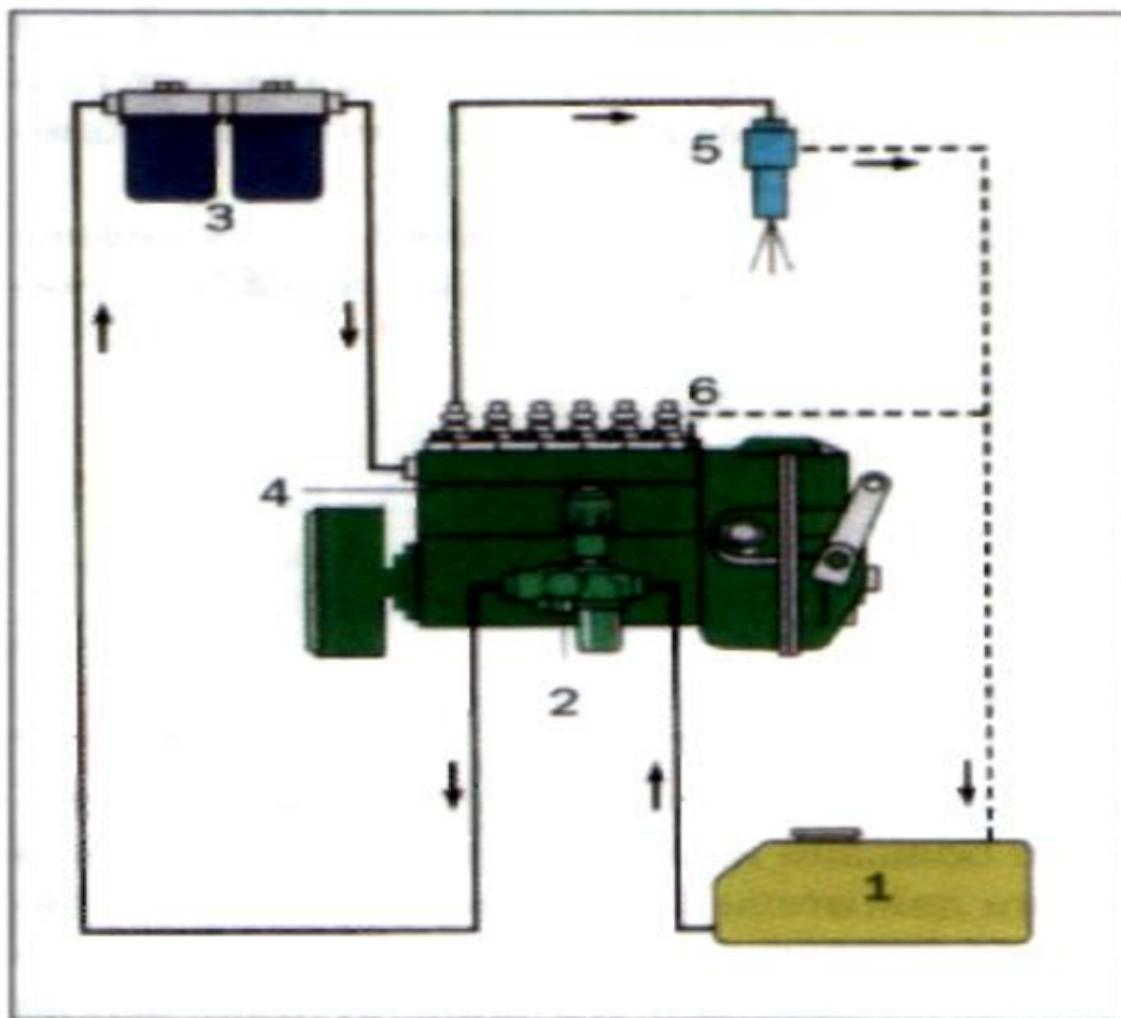
**Рис. 2.87. Схема системы питания дизеля:**
