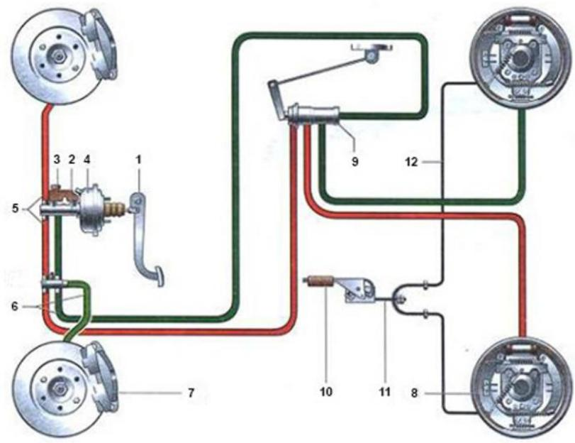
Рисунок 1 – Гидравлическая тормозная система с двойным контуром тормозов
