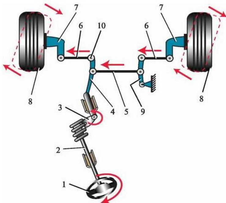
1 – рулевое колесо; 2 – рулевой вал с червяком; 3 – ролик с валом сошки; 4 – рулевая сошка; 5 – средняя тяга; 6 – боковые тяги; 7 – поворотные рычаги; 8 – передние колеса автомобиля; 9 – маятниковый рычаг; 10 – шарниры рулевых тяг
