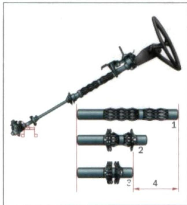
Рисунок 1 – травмобезопасная рулевая колонка
