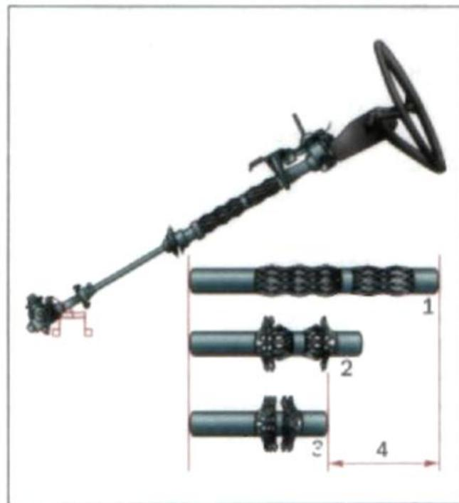
Рисунок 1 – травмобезопасная рулевая колонка
