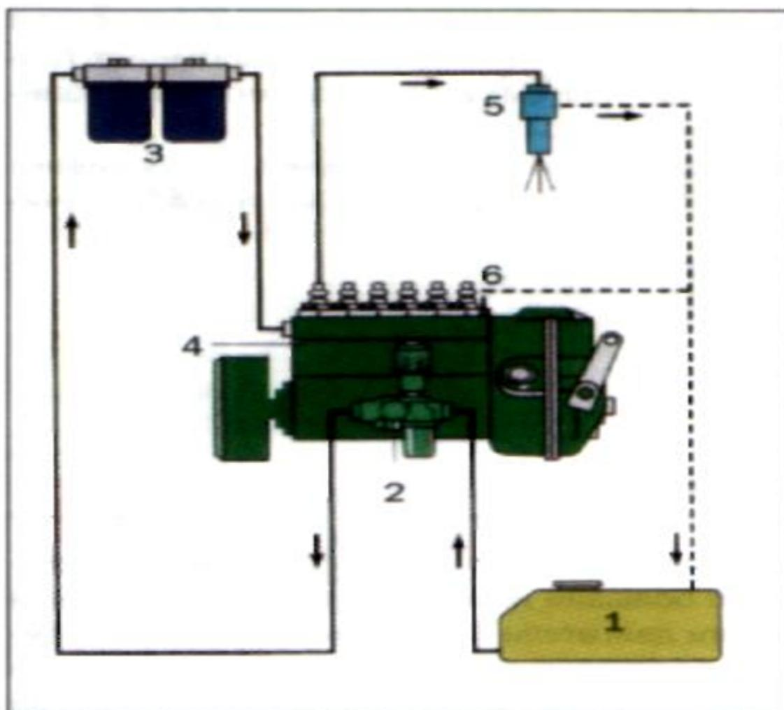
**Рис. 2.87. Схема системы питания дизеля:**
