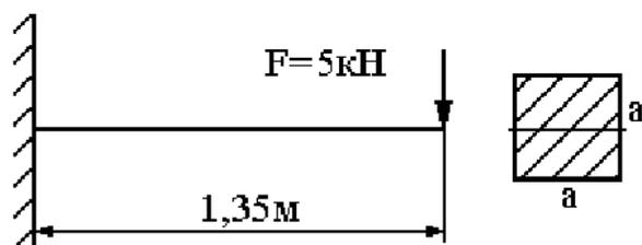
Задача №6: Выполнить расчет с применением стандартных методов расчета при проектировании деталей и узлов технологических машин и оборудования, а именно - определить максимальный прогиб стальной балки способом Верещагина.
