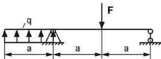
Задача №3 Выполнить расчет с применением стандартных методов расчета при проектировании деталей и узлов технологических машин и оборудования, а именно - основных законов механики и определить необходимое количество стальных заклепок допуская напряжение 120 МПа и диаметром 4 мм, если  $F=10 \text{ кН}$ .
