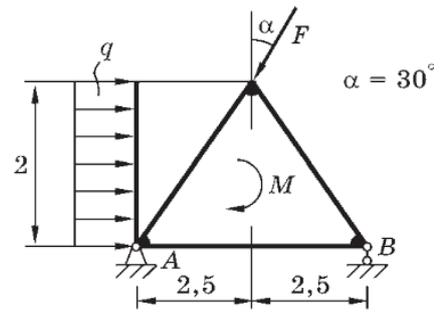
*2.Применение стандартных методов расчета при проектировании деталей и узлов технологических машин и оборудования. Задача на определение реакций связей.*
