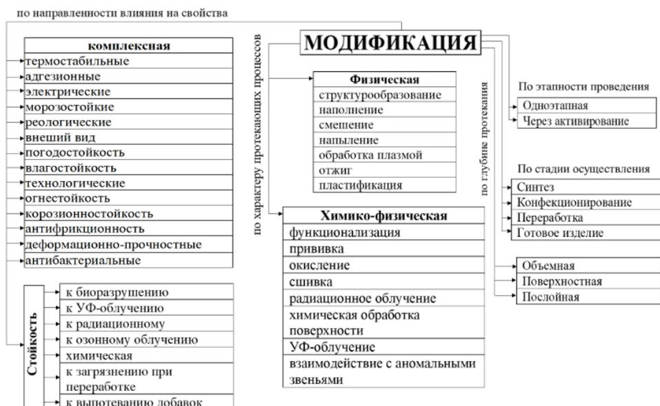
Рис.2. Классификация методов модификации полимерных материалов
