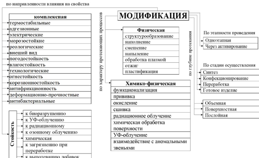
Рисунок 3 Классификация методов модификации полимерных материалов
