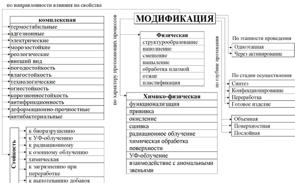
Рис.2. Классификация методов модификации полимерных материалов
