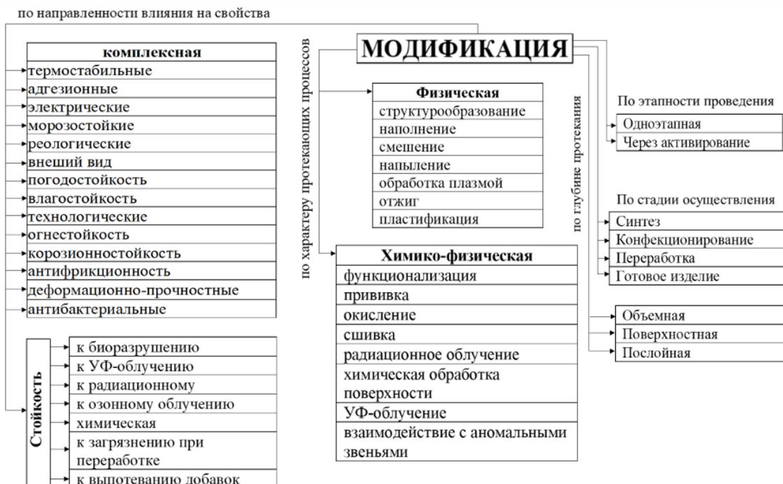
Рис.1. Классификация методов модификации полимерных материалов
