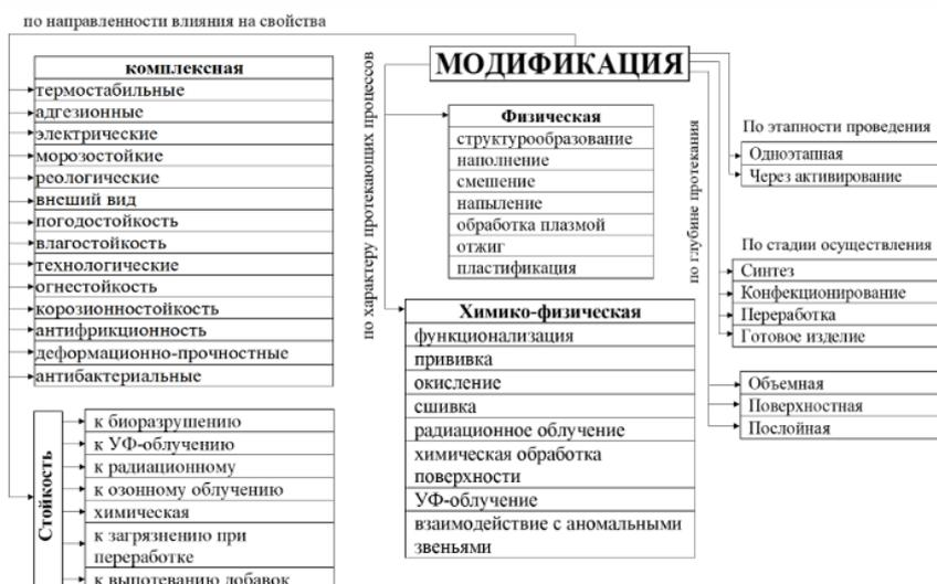
Рис.1. Классификация методов модификации полимерных материалов
