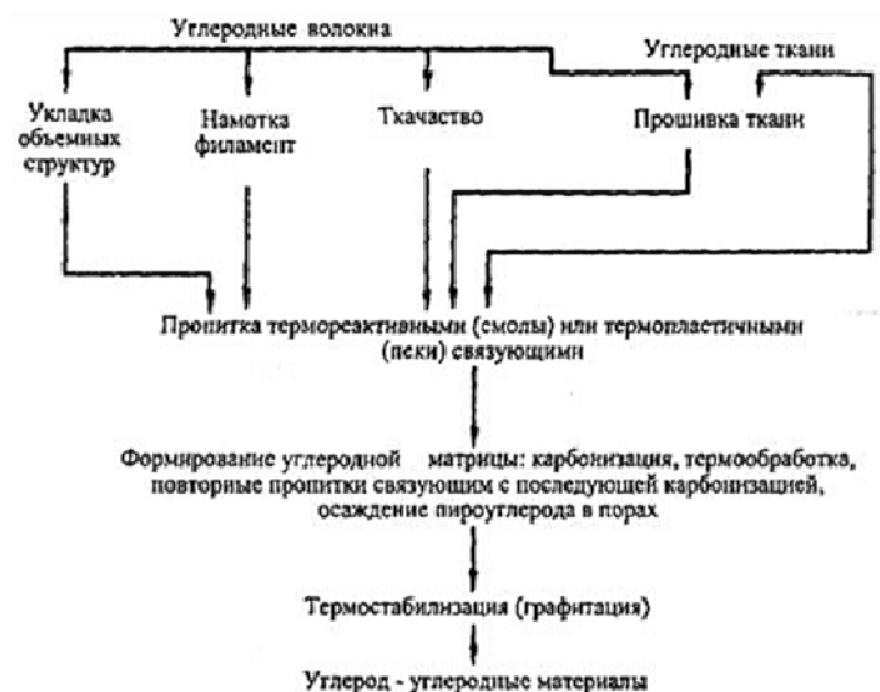
Рис. 2 Общая технологическая схема производства углерод-углеродных КМ
