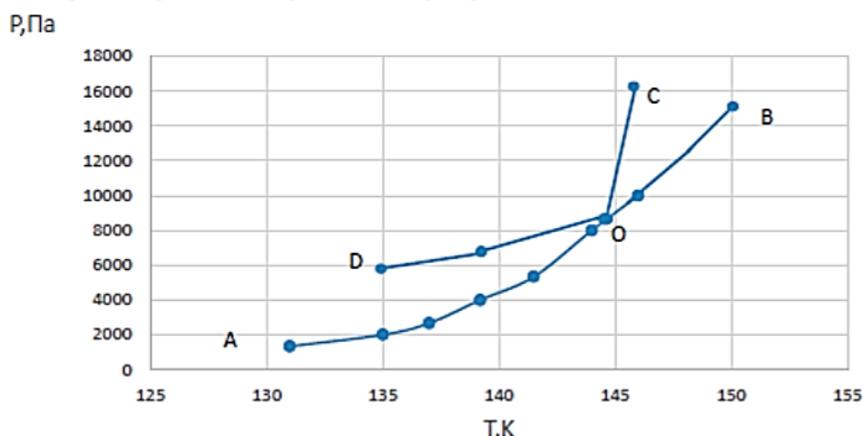
Рис. 1. График зависимости давления насыщенного пара чистого вещества от температуры
