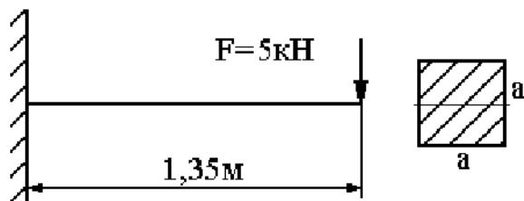
Задача №3 Выполнить расчет с применением общесинженерных знаний для решения производственных задач, а именно: определить максимальный прогиб стальной балки способом Верещагина.
