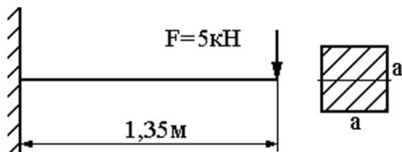
Задача №3 Выполнить расчет с применением общеинженерных знаний для решения производственных задач, а именно: определить максимальный прогиб стальной балки способом Верещагина.
