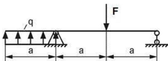
Задача №3 Выполнить расчет с применением общеинженерных знаний для решения производственных задач, а именно - основных законов механики и математики и определить необходимое количество стальных заклепок допускаемым напряжением 120 МПа и диаметром 4 мм, если  $F=10 \text{ кН}$ .
