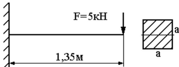
Задача №3 Выполнить расчет с применением общесинженерных знаний для решения производственных задач, а именно: определите максимальный прогиб стальной балки способом Верещагина.
