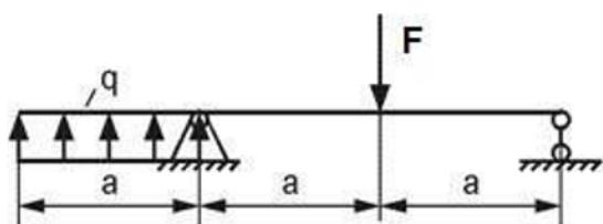
Задача №3 Выполнить расчет с применением общесинженерных знаний для решения производственных задач, а именно - основных законов механики и математики и определить необходимое количество стальных заклепок допускаемым напряжением 120 МПа и диаметром 4 мм, если  $F=10 \text{ кН}$ .
