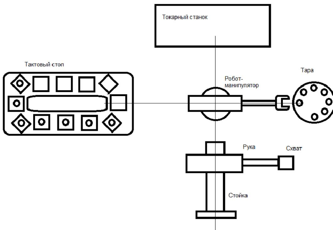
Требуется: составить таблицу состояний рабочих органов робота и построить циклограмму его работы согласно схеме изображенной на рисунке. Робот должен: из исходного положения взять заготовку из тары, установить в приспособление станка, после обработки снять обработанную заготовку со станка и положить на транспортную пластину тактового стола, вернуться в исходное положение. Заготовки в таре и на тактовом столе располагаются в вертикальном положении и на 300 мм ниже уровня приспособления станка.
