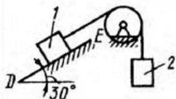
Определить наименьший вес тела 1, при котором оно скользит вниз по плоскости  $DE$ , если вес груза 2 равен 320 Н, коэффициент трения скольжения между телом 1 и плоскостью  $DE$  равен 0,2. (979)
