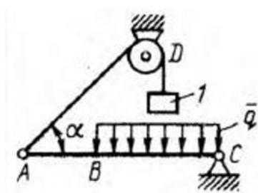
Балка  $AC$  закреплена в шарнире  $C$  и поддерживается в горизонтальном положении веревкой  $AD$ , перекинутой через блок. Определить интенсивность распределенной нагрузки  $q$ , если длины  $BC = 5$  м,  $AC = 8$  м, угол  $\alpha = 45^\circ$ , а вес груза  $l$  равен 20 Н. (9,05)
