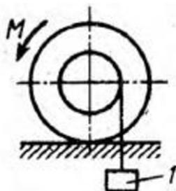
К однородному катку, малый радиус которого 0,2 м, подвешен груз  $I$  весом 200 Н и приложена пара сил с моментом  $M = 57,6 \text{ Н} \cdot \text{м}$ . Определить в кН наибольший вес катка, при котором он будет катиться влево, если коэффициент трения качения  $\delta = 0,008 \text{ м}$ . (2,0)
