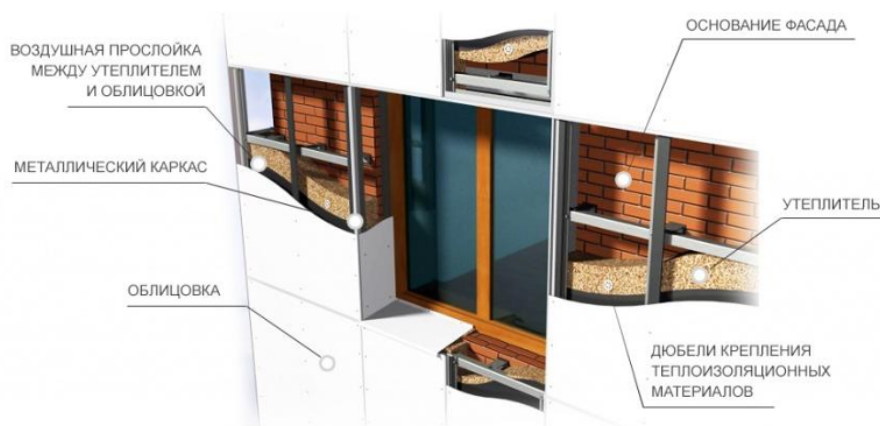
Рисунок 1 – Схема вентилируемого фасада
