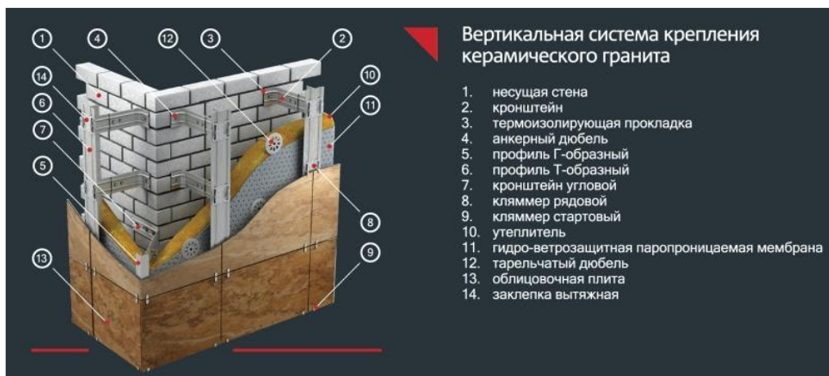
Рисунок 2 – Описание элементов конструкции вентфасада
