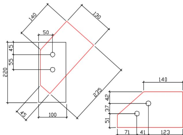
Применить прикладное программное обеспечение (средства графической системы AutoCAD) для простановки размеров на строительных чертежах.
