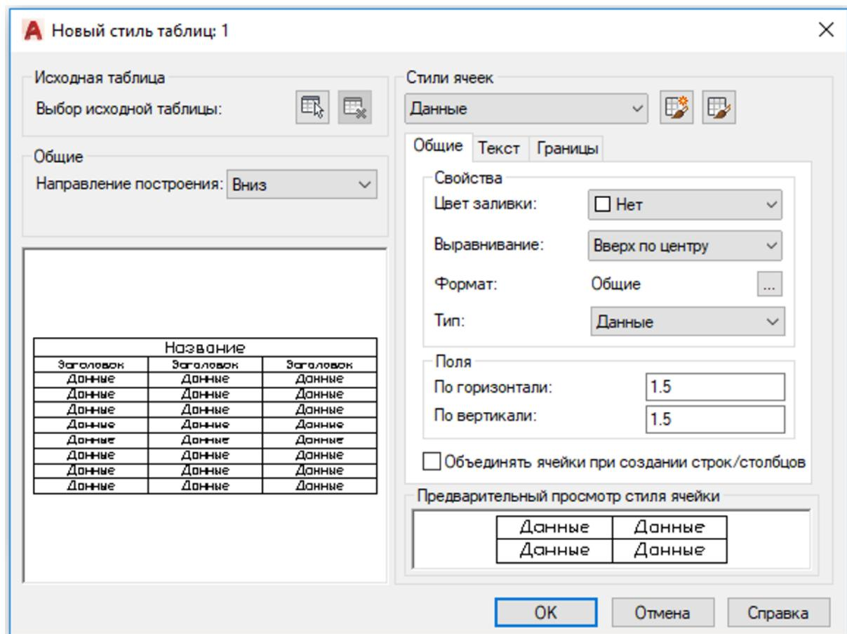
12. Применить средства прикладного программного обеспечения (графической системы AutoCAD) для создания таблиц на основе разработанных табличных стилей
