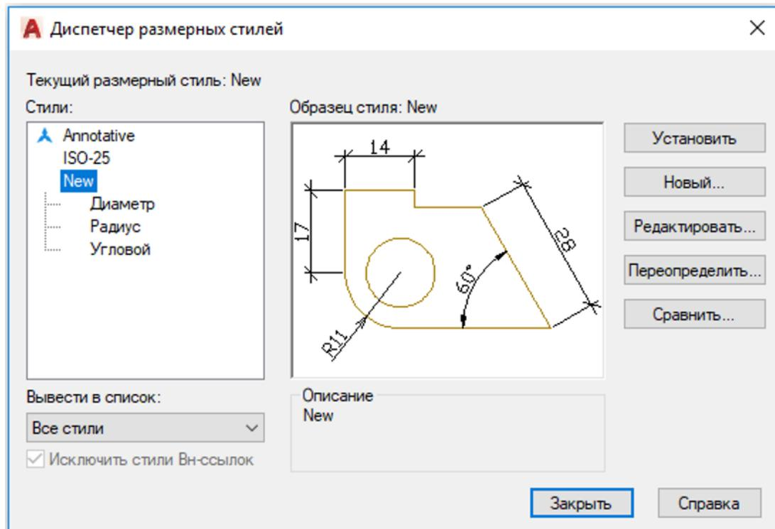
10. Применить прикладное программное обеспечение (средства графической системы AutoCAD) для простановки размеров на строительных чертежах.
