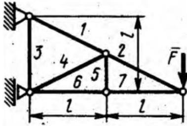
Определить усилие в стержне 6. Сила  $F = 360 \text{ Н.}$  ( $-720$ )
