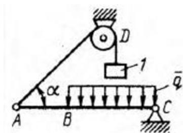
Балка  $AC$  закреплена в шарнире  $C$  и поддерживается в горизонтальном положении веревкой  $AD$ , перекинутой через блок. Определить интенсивность распределенной нагрузки  $q$ , если длины  $BC = 5$  м,  $AC = 8$  м, угол  $\alpha = 45^\circ$ , а вес груза  $1$  равен  $20$  Н. (9,05)
