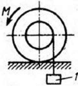
К однородному катку, малый радиус которого 0,2 м, подвешен груз  $G$  весом 200 Н и приложена пара сил с моментом  $M = 57,6 \text{ Н} \cdot \text{м}$ . Определить в кН наибольший вес катка, при котором он будет катиться влево, если коэффициент трения качения  $\delta = 0,008 \text{ м}$ . (2,0)
