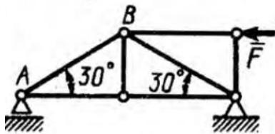
Определить усилие в стержне  $AB$ , если сила  $F = 346 \text{ Н}$ . (-200)
