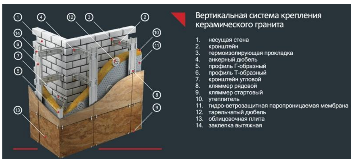
Рисунок 2 – Описание элементов конструкции вентфасада
