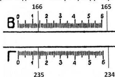
Поле зрения отсчетного устройства теодолита 2Т30М
