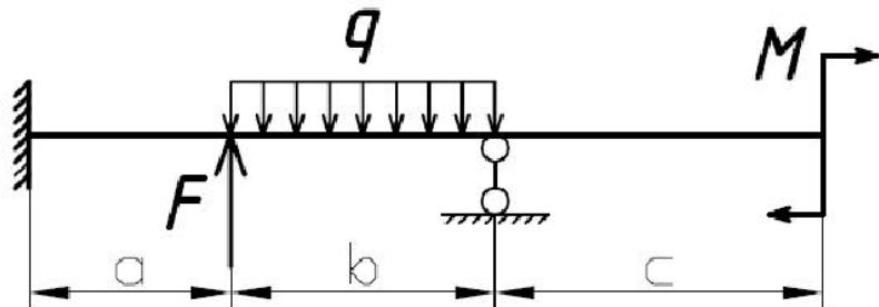
Задача №11: Дано:  $a = 2 \text{ м}$ ;  $F = 11 \text{ кН}$ ;  $q = 8 \text{ кН}/\text{м}$ .
