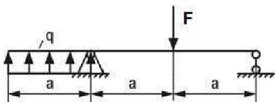
Задача № Выполнить расчет с применением стандартных методов расчета при проектировании деталей и узлов изделий машиностроения, а именно - основных законов механики и определить необходимое количество стальных заклепок допускаемым напряжением 120 МПа и диаметром 4 мм, если  $F=10 \text{ кН}$ .
