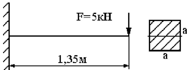
Задача №9: 3 Выполнить расчет с применением стандартных методов расчета при проектировании деталей и узлов изделий машиностроения, а именно - определить максимальный прогиб стальной балки способом Верещагина.
