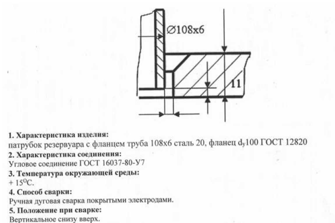
Рисунок 18 – Эскиз сварного соединения
