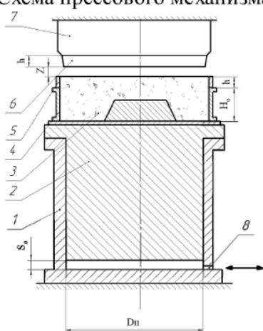
1 – прессовый цилиндр; 2 – прессовый поршень; 3 – модель; 4 – опока; 5 – наполнительная рамка; 6 – прессовая колодка; 7 – траверса; 8 – отверстие для выпуска воздуха в прессовый цилиндр
