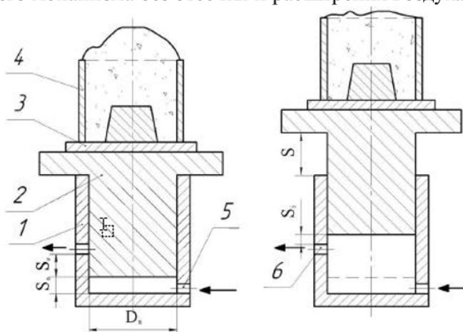
1 – встряхивающий цилиндр; 2 – встряхивающий поршень; 3 – подмодельная плита с моделью; 4 – опока; 5 – выпускное отверстие; 6 – выпускное отверстие
