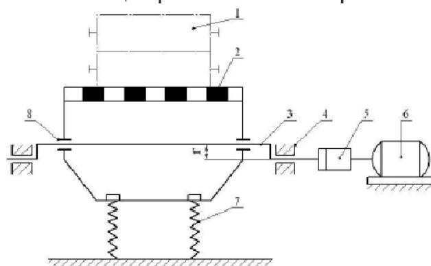
1 – форма; 2 – корпус решетки; 3 – эксцентриковый вал; 4 – опоры вала; 5 – муфта; 6 – электродвигатель; 7 – амортизаторы; 8 – опоры вала
