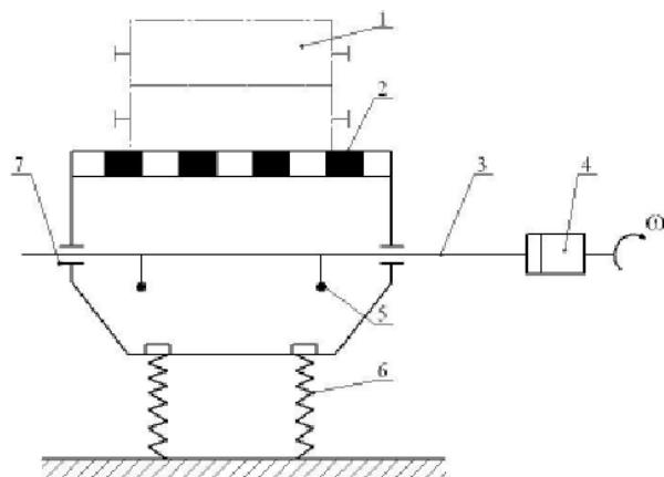
1 – форма; 2 – корпус решетки; 3 – приводной вал; 4 – муфта;
