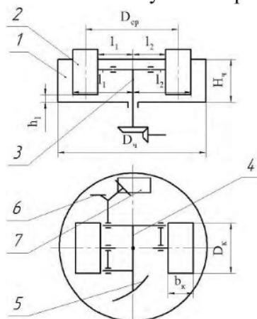
1 – неподвижная чаша; 2 – катки; 3 – вертикальный вал; 4 – траверса; 5, 6 – плужки; 7 – разгрузочный люк
