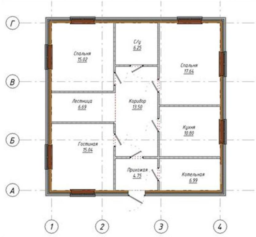
Рисунок 1 – План 1-го этажа малоэтажного жилого здания
