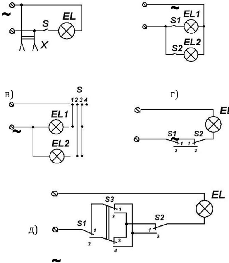
Рисунок 1 - Принципиальные схемы включения одной лампы с выключателем и штепсельной розеткой (а), двух ламп со своими выключателями (б) или с люстровым выключателем (в), одной лампы с управлением из двух (г) и трех (д) мест
